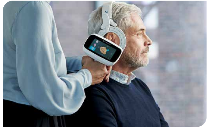
Das Handwerk nutzt modernste Technologien – hier erfolgt die Ohrabformung mit 3-D-Scanner, statt das äußere Ohr mit Silikon abzuformen. (Foto: Otoscan)
